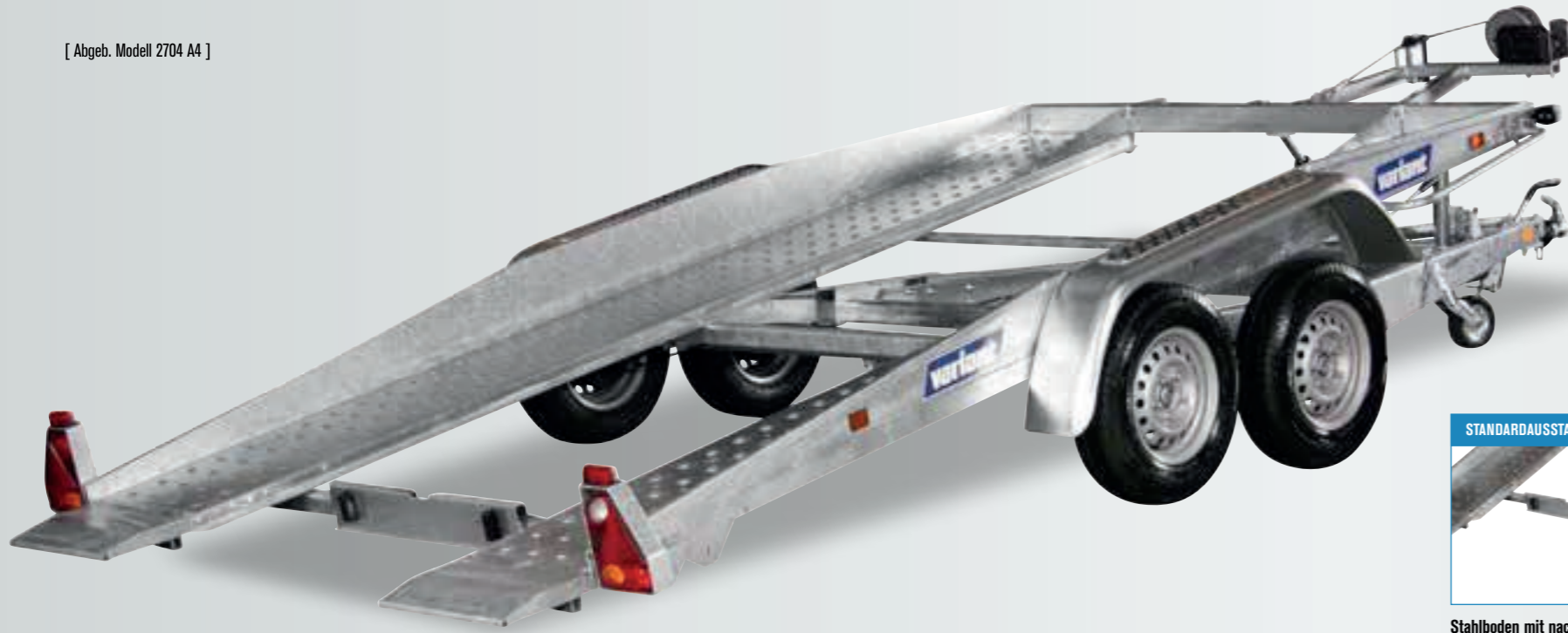
STANDARD-AUSSTATTUNG Stahlboden mit nach oben gehenden Löchern. Stark und Rutschfest.
